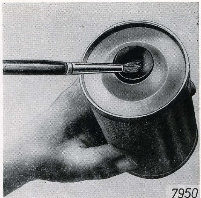
6 – 23 ábra A szűrőtömitőgyűrűk benedvesítése összeszerelés előtt
