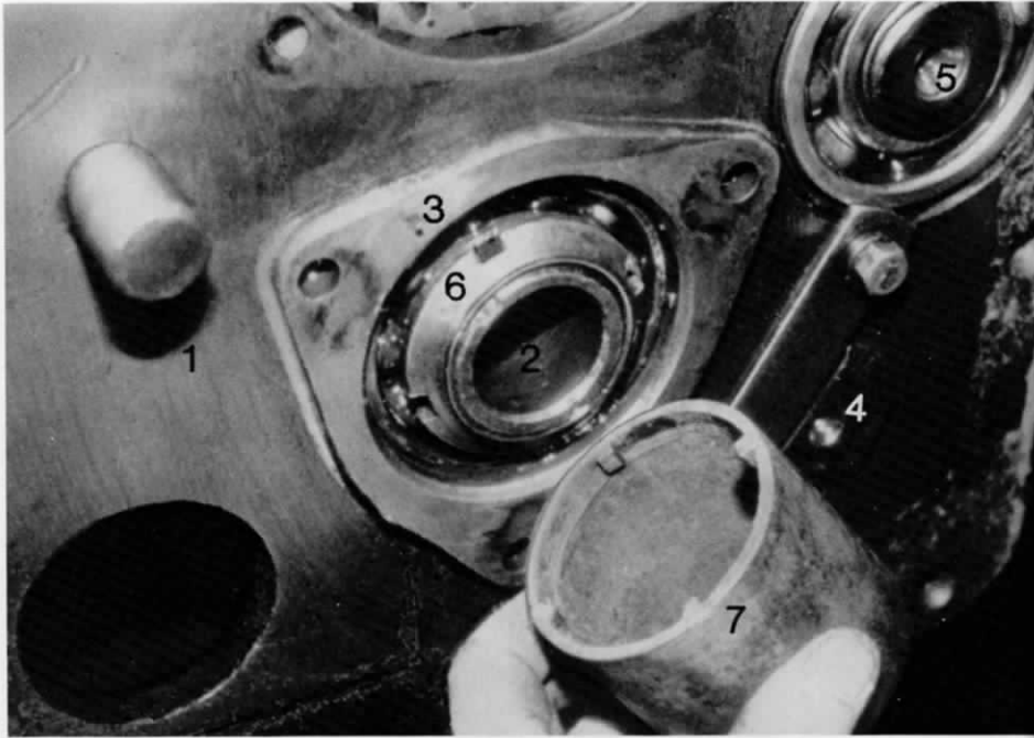
65. ábra. A hornyos csapágyanya leszerelése belsőkörmös szerszámmal
