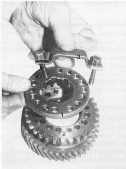
39. ábra. A befecskendezőszivattyút hajtó fogaskerék szerelése
