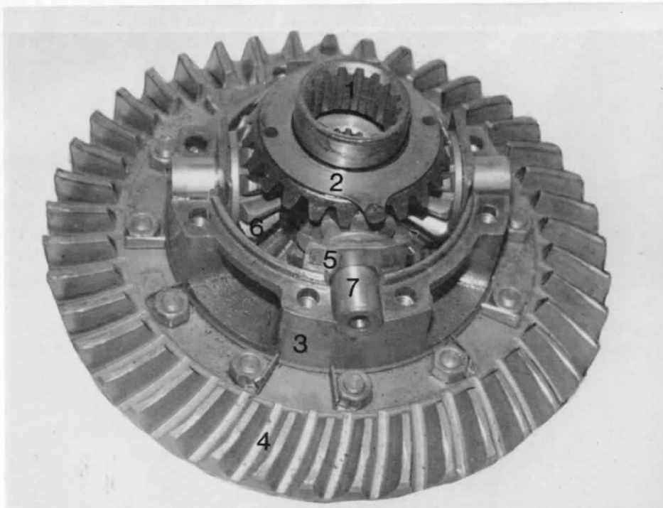
86. ábra. A differenciálmű 1. féltengely-fogaskerék, 2. alátét, 3. differenciálmű-ház, 4. a főáttétel hajtott tányérkereke, 5. kagylós alátét, 6. bolygókerék, 7. közbenső tárcsa
