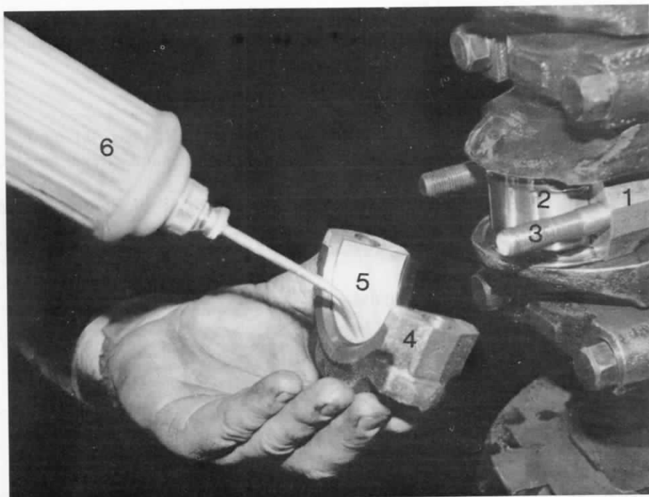
30. ábra. A hajtórúd csapágyerselyének szerelés előtti olajozása
