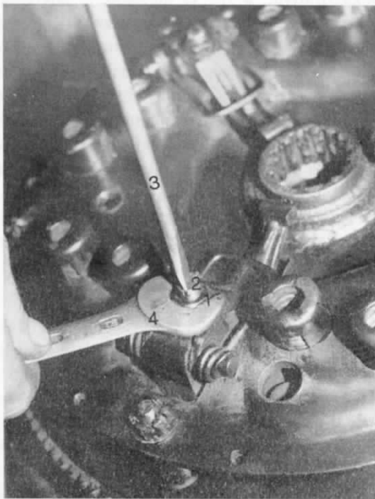
45. ábra. Az állítócsavarok biztosítása ellenanyával
