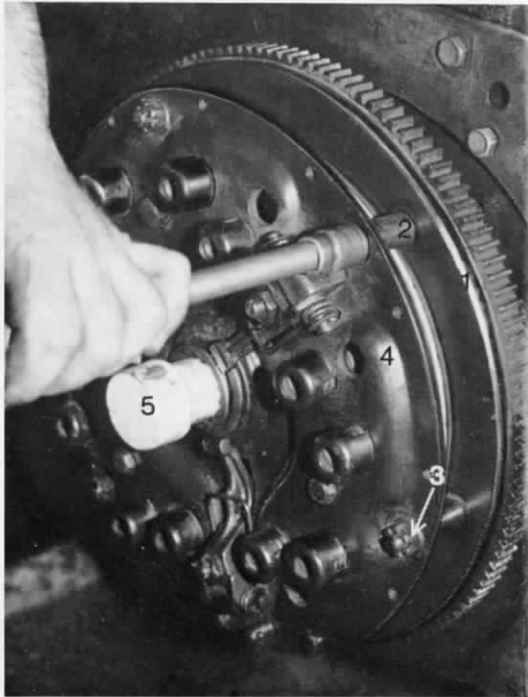
42. ábra. A kapcsolószerkezetet rögzítő csavaranyák meghúzása 1. lendkerék, 2. menetes csap, 3. csavaranya, 4. támasztótárcsa, 5. szerelőtengely
