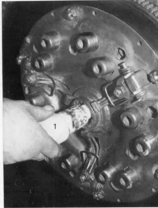
43. ábra. A szerelőtengely kihúzása 1. szerelőtengely
