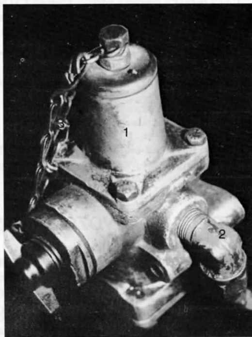
145. ábra. Nyomásszabályozó szelep a traktoron 1. szelep, 2. csatlakozás a légsűrítőhöz, 3. csatlakozás a légtartályhoz
