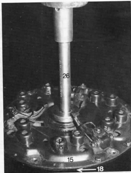
48. ábra. A tengelykapcsoló nyomórugóinak összeszorítása préssel a szerelőcsavarok ki- és behajtásához
