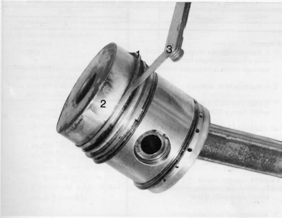
28. ábra. A dugattyúgyűrű—gyűrűhorony illeszkedési hézagának ellenőrzése 1. dugattyúgyűrű, 2. dugattyú, 3. hézagmérő
