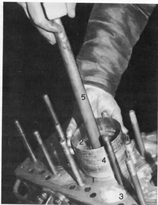
34. ábra. A dugattyú illesztése a hengerperselybe a dugattyúgyűrűket összeszorító készülék segítségével
