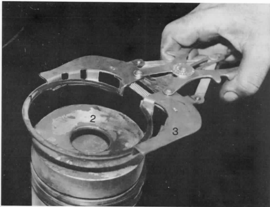
26. ábra. A dugattyúgyűrű szerelése gyűrűszerelő fogóval 1. dugattyúgyűrű, 2. dugattyú, 3. dugattyúgyűrű-szerelő fogó
