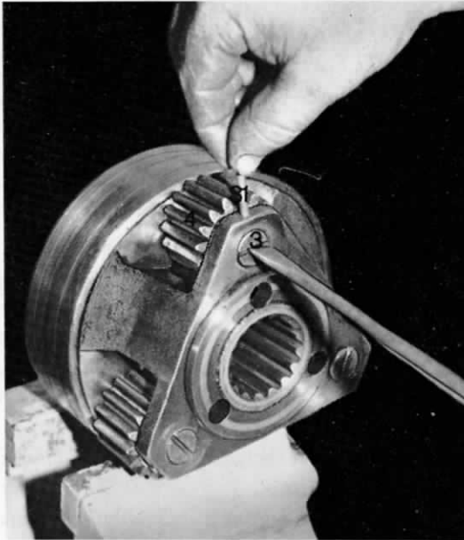
90. ábra. A bolygókeréktengely biztosítása 3. bolygókeréktengely, 4. bolygókerék, 31. csőszeg
