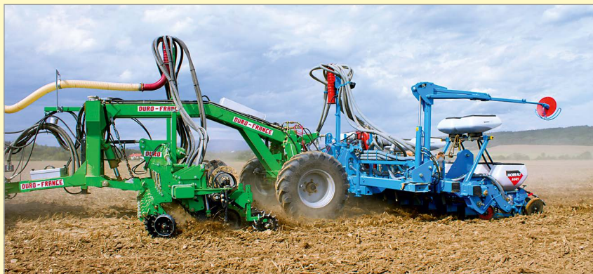
6. ábra Duro France Strip Till Intégral sávművelő műtrágyakijuttatással + Monosem NG Plus 12-soros kukoricavető gép
