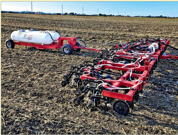
9. ábra Case IH Nutri Tiller 950 sáv-művelő 3-sorban elhelyezett művelőelemekkel
