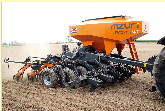
7. ábra Mzuri Pro-Til 4T sávművelő-gabonavető gép
