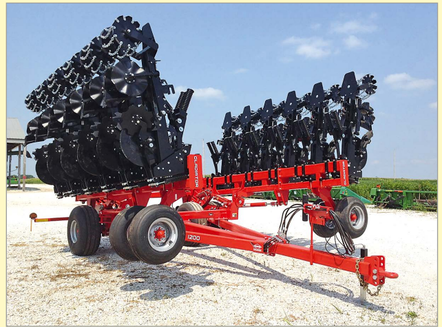
10. ábra Kuhn Krause Gladiator 1200 vontatott, 12 soros sáv-művelő szállítási helyzetében
