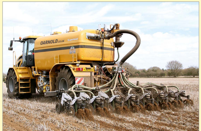
5. ábra Sly Agri Stripcat-8 sávművelő hígtrágya-kijuttatással
