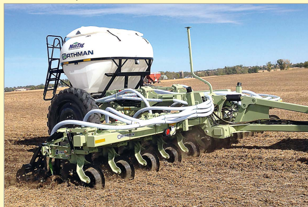
8. ábra Orthman 1tRiPr XD sávművelő MonTag műtrágya-kijuttató kocsival összekapcsolva
